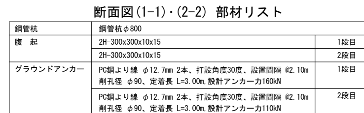
削孔延長計【断面図(1.2)】
